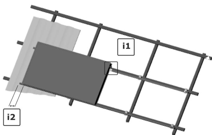
**i1** Horní Háky Vario (4) instalovat cca 300 mm od horní hrany kolektorů
